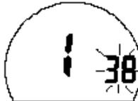
3. Appuyer sur **PTT** pour fixer et mémoriser le canal CTCSS, ou bien l'appareil mémorisera de lui-même le réglage affiché à l'écran après 15 secondes. Le mode balayage se remettra à chercher le canal CTCSS suivant si aucun bouton n'est pressé après 5 secondes.
